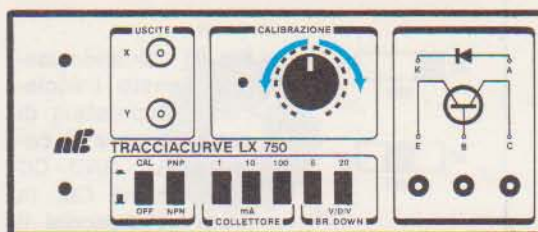
Fig. 24 Dopo aver premuto il pulsante CALIBRAZIONE, dovrete ruotare la manopola presente sul pannello frontale, in modo da ottenere una traccia come visibile in fig. 25.
