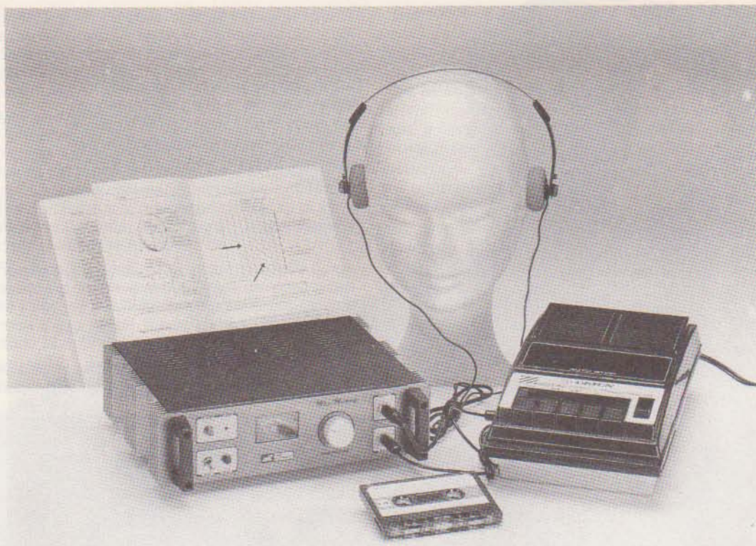
Fig. 1 Per sfruttare l'effetto di sublimazione, il circuito Max-Memory andrà collegato ad un qualsiasi registratore, entro al quale avrete inserito una cassetta ad avvolgimento continuo, con sopra registrato quello che desiderate imparare durante le ore di sonno.
